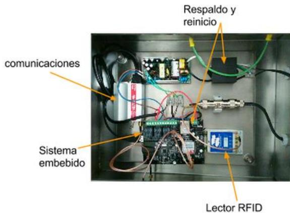
Figura 4. Montaje realizado del sistema de hardware
